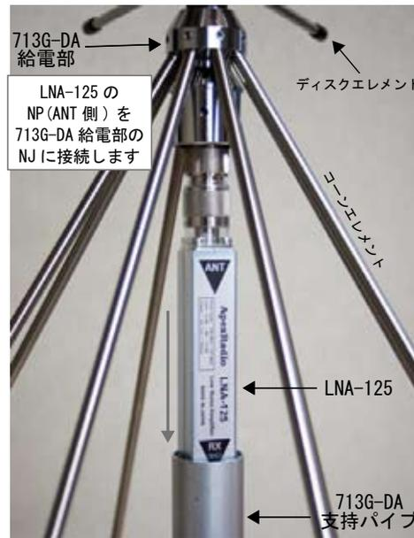
LNA-125 の NJ (RX 側) に 713G-DA の支持パイプ内を通した同軸ケーブルの NP を接続、給電部に装着した LNA-125 を支持パイプ内に収めて固定ボルトで固定します
